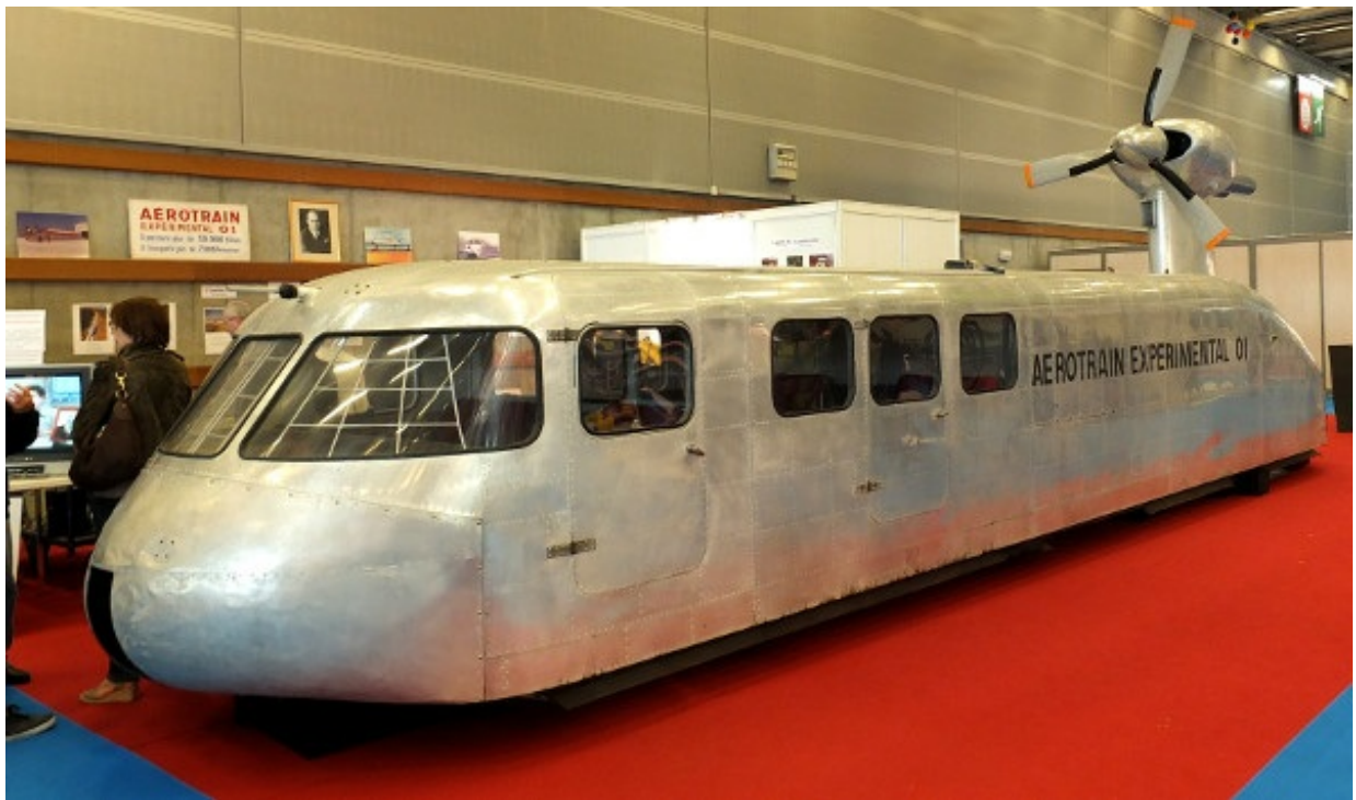
Abb. 2: Der in Frankreich entwickelte Aérotrain (dt. „Luftzug“), ein schienengebundenes Luftkissenfahrzeug.
