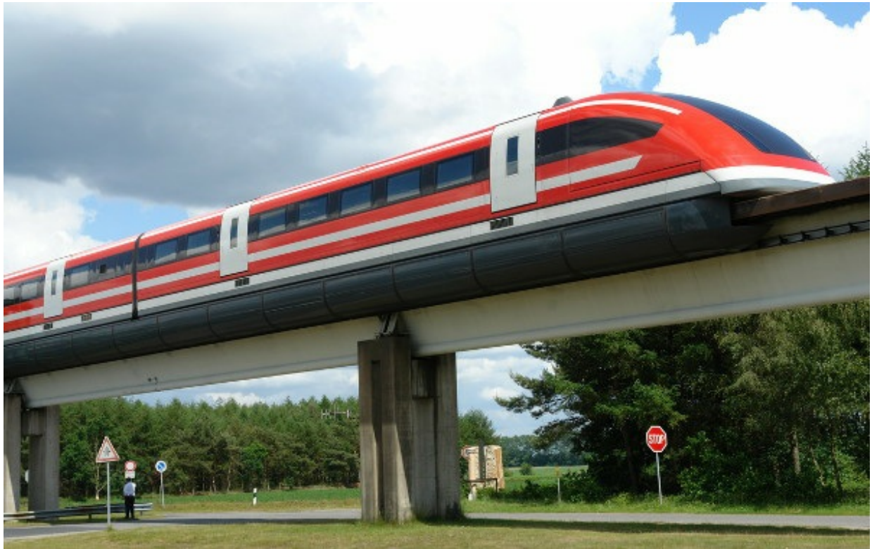
Abb. 1: Die in Deutschland entwickelte Magnetschwebbahn Transrapid auf der Versuchsstrecke im Emsland.
