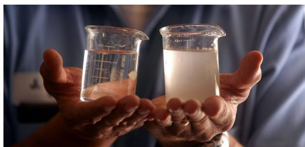
A partir de 100 litres d'eau de mer, le dessalement permet d'obtenir 52 litres d'eau douce et 48 litres d'eau saumâtre (la « saumure »).
