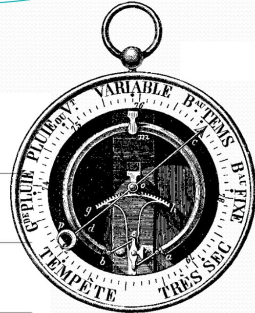
Fig. 283. — Baromètre de Bourdon.
